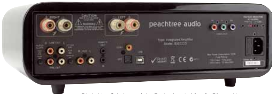
Die beiden Schalter auf der Rückseite sind für die Filterwahl und Jitter. Alle Eingänge sind per Trafo entkoppelt
